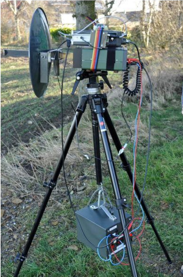
Bild 5 (DK4REX): 10 GHz-Station mit „freischwebendem“ Akku an der Mittelsäule des Stativs.
