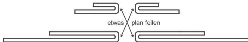
1. vier Haarnadelförmige Dipolhälften aus 1,5 mm CuAg-Draht biegen und auf Maß ablängen
